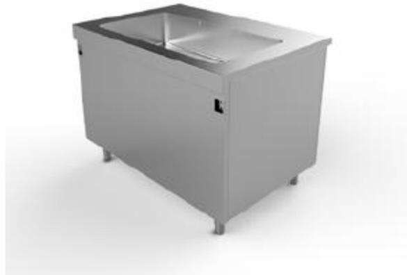
Meuble self-service réalisé entièrement en acier inox AISI 304, constitué d'une cuve bain-marie emboutie et rayonnée, épaisseur 20/10 et profondeur 215 mm, et d'une armoire chauffante avec portes coulissantes. Pieds avec vérins réglables. Réglage de la température de la cuve et de l'armoire respectivement de +30°C ÷ +80°C et de +30°C ÷ +70°C par thermostat. Maintien automatique du niveau d'eau. Disponible dans les dimensions 3-4-5-6 GN.
