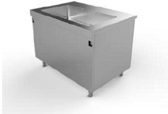
Meuble self-service réalisé entièrement en acier inox AISI 304, constitué d'une cuve chauffante ventilée, emboutie et rayonnée, épaisseur 20/10 et profondeur 215 mm, et d'un placard à baie ouverte. Pieds avec vérins réglables. Réglage de la température de +30°C ÷ +80°C par thermostat. Disponible dans les dimensions 3-4-5-6 GN.
