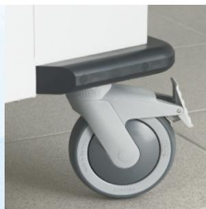
Les chariots sont équipés de façon standard de 4 roues inoxydables (selon DIN 18867-8), deux sont fixes, deux sont pivotantes à frein. D'un diamètre de 125 mm, elles disposent en outre d'une protection pare fils. En option, il est possible de mettre des roulettes de diamètre 160 ou 200 mm. En cas de sol difficile, il est également possible de mettre une roue centrale pour faciliter encore plus la maniabilité du chariot.
