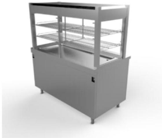
Meuble self-service entièrement en acier inox AISI 304, constitué d'une vitrine réfrigérée avec plan réfrigéré sur soubassement réfrigéré. Groupe logé unique pour plan, vitrine et soubassement. Régulation indépendante de la température de +2°C ÷ +12°C par téléthermostat digital. Doté de pieds avec vérins réglables.
