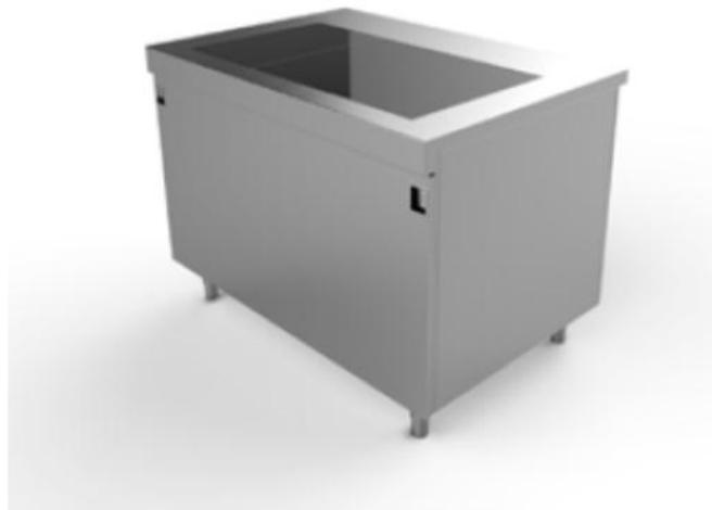
Meuble self-service réalisé entièrement en acier inox AISI 304, constitué d'un plan vitrocéramique de maintien en température et d'une armoire chauffante à portes coulissantes. Pieds avec vérins réglables. Réglage de la température du plan et de l'armoire respectivement de +30°C ÷ +110°C et de +30°C ÷ +70°C par thermostat. Disponible dans les dimensions 3-4-5-6 GN.
