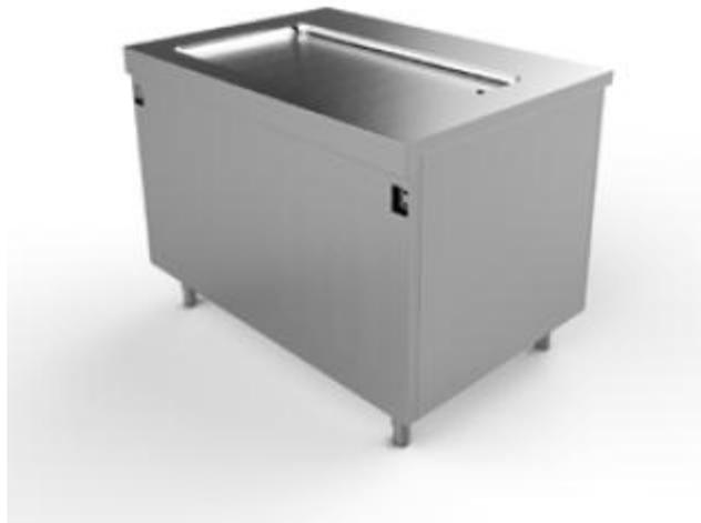
Meuble self-service réalisé entièrement en acier inox AISI 304, constitué d'un plan réfrigéré embouti e rayonné épaisseur 20/10 et d'un soubassement réfrigéré à porte battante. Décaissé de 30 mm. Groupe logé. Isolation par mousse de polyuréthane injectée. Réfrigération statique. Pieds avec vérins réglables. Régulation de la température de +2°C ÷ +12°C par téléthermostat digital. Disponible dans les dimensions 3-4-5-6 GN.
