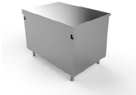
Meuble neutre sur baie ouverte réalisé entièrement en acier inox AISI 304, constituée d'un plan de travail en 20/10 et de pieds avec vérins réglables.
