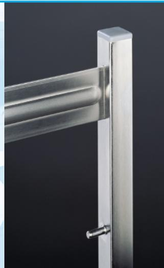
Les ergots sont en acier rond de 7 mm solidement soudés sur le tube. La traverse est un profil plat inséré dans le tube selon un procédé breveté. Un capuchon en PVC ferme le tube des échelles en partie supérieure.
