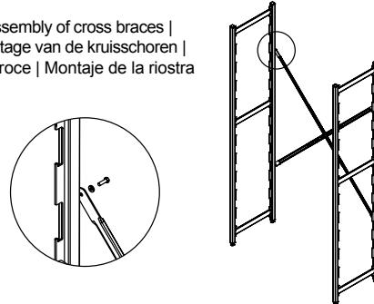
**D** Montieren Sie jetzt die Kreuzverstrebung an dem einen und danach an dem zweiten Regalständer. Benutzen Sie hierzu das mitgelieferte Befestigungsmaterial.
