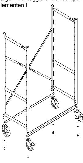
**D** Zur Erhöhung der Formstabilität müssen die Regalständer jeweils auf der Vorder- und Rückseite mit einem Winkelverbinder verbunden werden.
