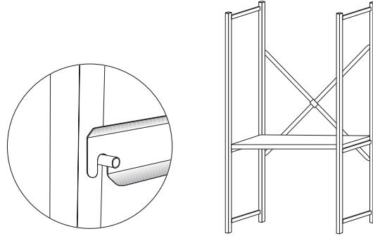
**4** Übereckmontage | Diagonal assembly | Montage d'angle | Hoekaanbouw-montage | Montaggio ad angolo | Montaje de través en un rincón
