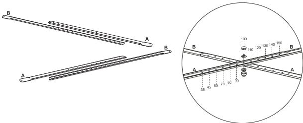
**2** Montage der Kreuzstrebe | Assembly of cross braces | Montage de l'entretoise | Montage van de kruisschoren | Montaggio della traversa a croce | Montaje de la riestra en cruz
